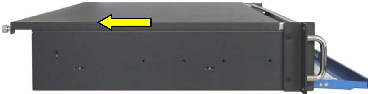
Abb. 27: Die Fixierungslaschen des Deckels werden aus den Deckelhalteplatten des Gehäuses herausgezogen.
