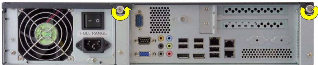
Abb. 26: Lösen der Rändelschrauben an der Rückseite
