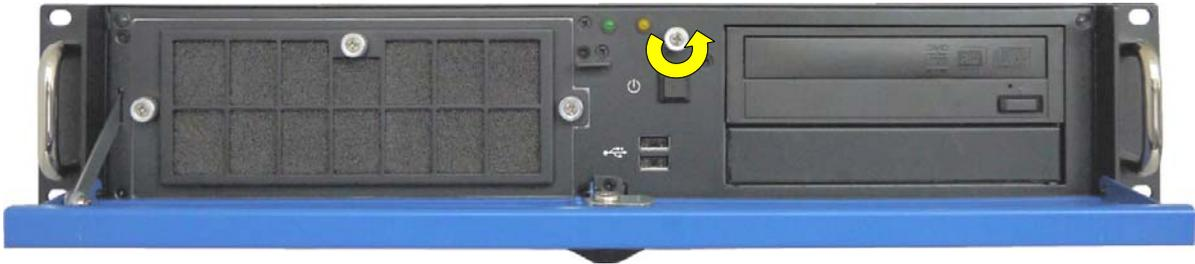
Abb. 25: Lösen der Deckel-Anziehschraube an der Frontseite
