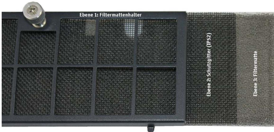
Abb. 47: IP52 Ausführung - Anordnung des Schutzgitters und der Filtermatte im Filtermattenhalter
