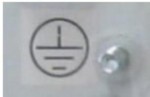
Abb. 19: Erdungsbolzen gekennzeichnet mit PE-Symbol
