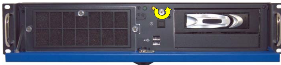
Abb. 32: Lösen der Deckel-Anziehschraube an der Frontseite
