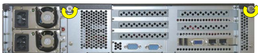
Abb. 33: Lösen der Rändelschrauben an der Rückseite
