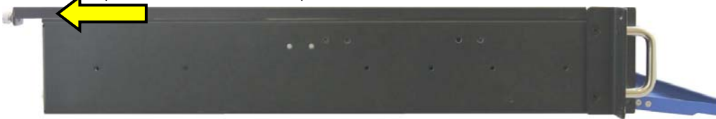
Abb. 34: Durch diese Bewegung werden die Zentrier- und Fixierungslasche des Deckels, aus der Deckelhaltetasche herausgezogen.
